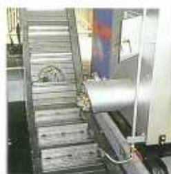
2. 熔融炉からスクリーによって 押し出される熔融廃プラ →水槽へ冷却
