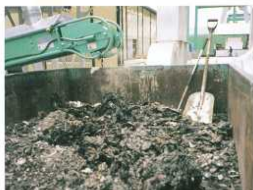
3. 木粉混入固形物（ボイラーの燃料利用）
