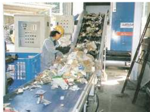
1. 選別された廃プラをコンベヤで投入。
