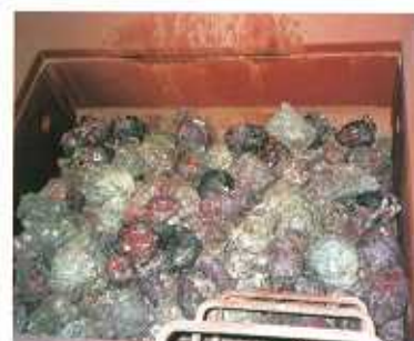
3. 受箱に集められた固形物(高炉化原料として利用)
