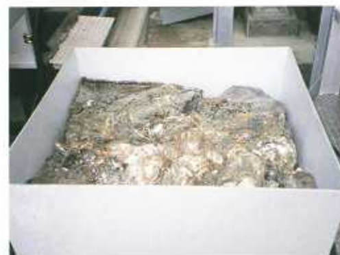
3. 溶融物受箱（W.800×D.800×H.400） （大型焼却炉にて処理、埋立地の延命化）
