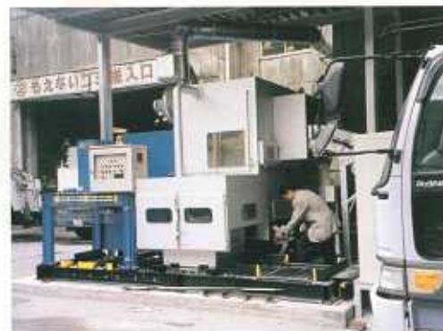
2. 溶融受箱は左側へ移動して再度強力プレス圧縮される。
