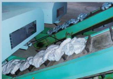
●溶融物をロータリーカッターにてカット 搬出コンベヤーへ
