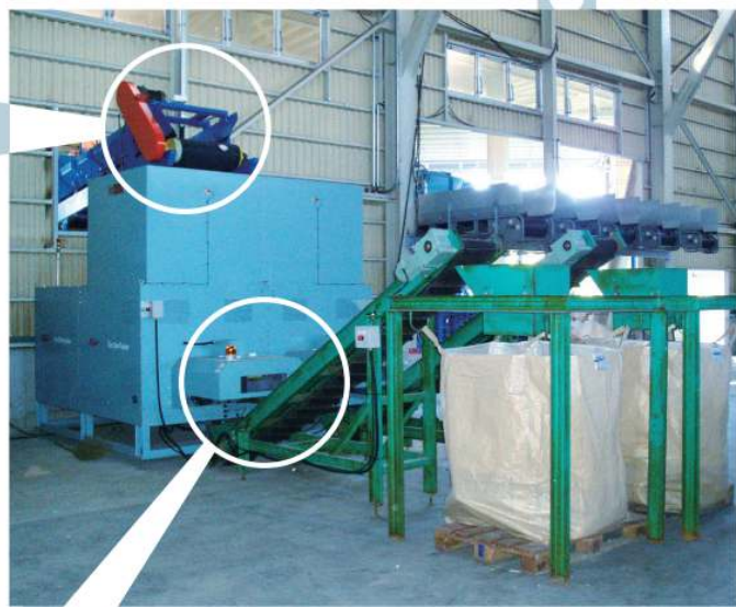
●2系列に並んだフレコン袋へ収納中 フレコン袋へ収納されるため、1袋700kg(2袋1400kg) くらいに一度交換すれば良いので、作業性が良い
