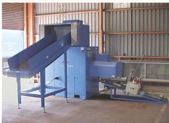
■ 簡易投入コンベヤー + オートカット式（波板取型） （S社） 本体はEAP-800S
